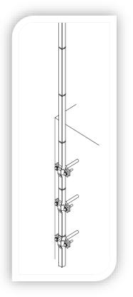
**Application** Mast ≤ 2m : 2 Brackets Mast > 2m : 3 Brackets
